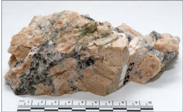
Рис. 5. Зразок порфіроподібного граніту (пр. 15/23)
