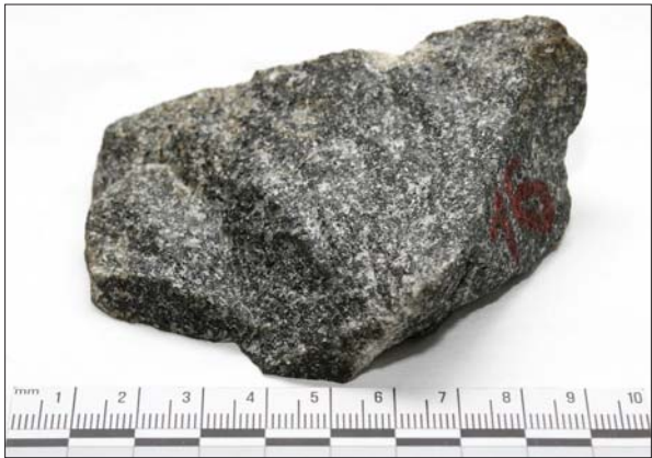
Рис. 8. Зразок піроксенового плагіогнейсу (пр. 16/23)
