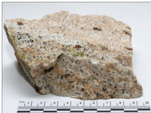
Рис. 2. Зразок нерівномірностерного гранатвмісного граніту (пр. 14/23)
